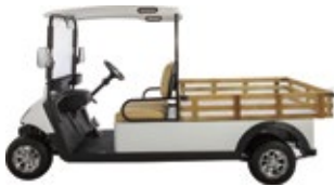
· Shuttle A/B木货箱 木货箱尺寸:1505*1180*310 mm
